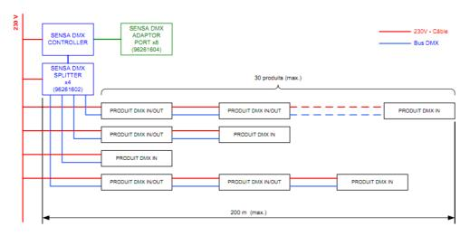
Principe de câblage 3 : Contrôleur DMX avec splitters en cascade (adaptor port en option)
