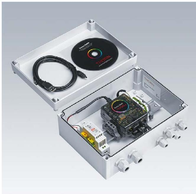
Contrôleur DMX autonome et dispositifs associés pour la mise en place des réseaux DMX dans le cadre d'applications de plein air
